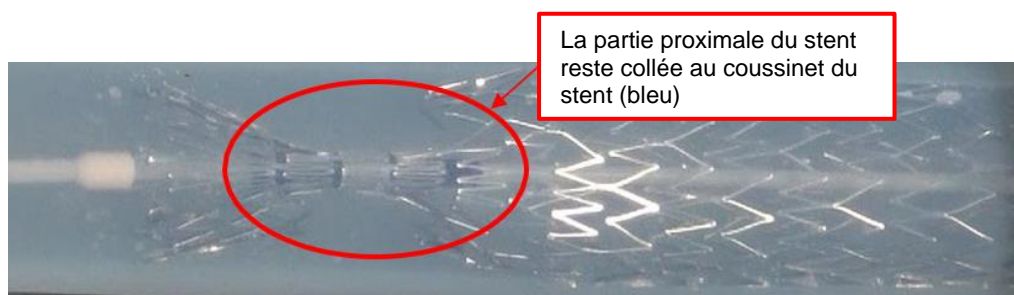
Figure 1 : L'extrémité proximale du stent reste connectée au matériau du coussinet du stent.
